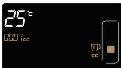
流量顯示將從0開始計算出水，最多2000cc自動停止以防溢漏。
